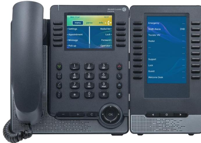
Les capacités du téléphone peuvent être étendues avec des modules d'extension : Le module d'extension de l'EM-200 offre jusqu'à 120 touches LED supplémentaires. Chaque page virtuelle comprend 2 x 10 touches LED programmables. L'EM-200 peut afficher jusqu'à 2 pages virtuelles. Il est possible de connecter jusqu'à 3 modules EM-200 à l'ALE-30h.
